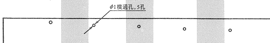
图 A.1 JM-1 型气门试块
