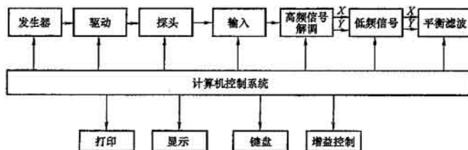
图 1 涡流仪功能框图
